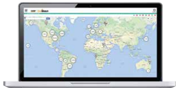
Carte de localisation de la machine : surveillance et suivi de la position de la machine. Utilisation courante : gestion du parc, établissement d'un périmètre.
