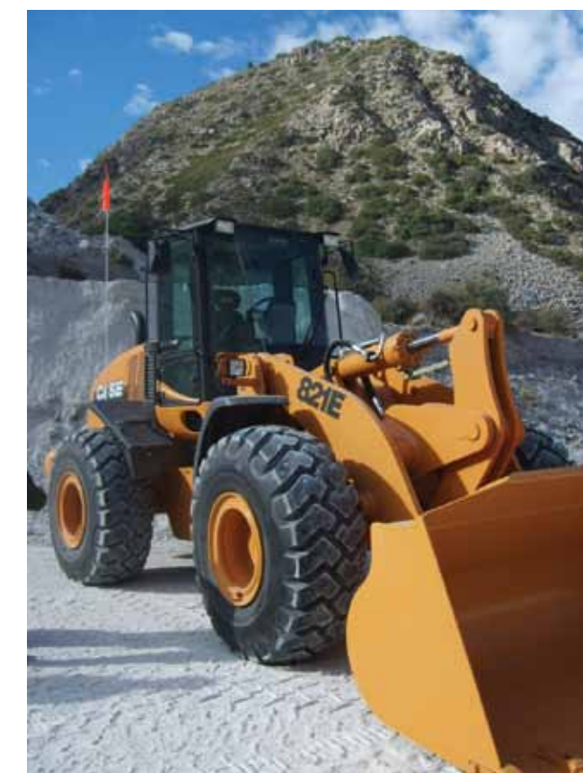
La cargadora frontal es utilizada en la obra para cargar camiones y en la alimentación de buzones.
