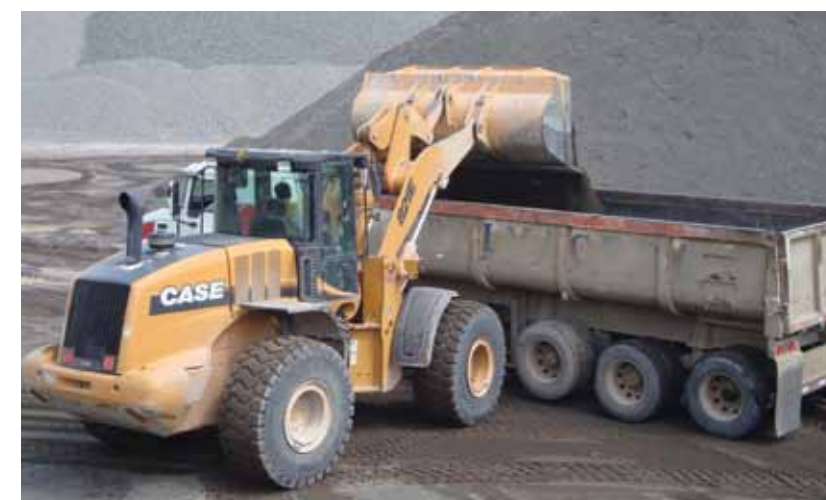
La cargadora frontal es utilizada en la obra para cargar camiones y en la alimentación de buzones.
