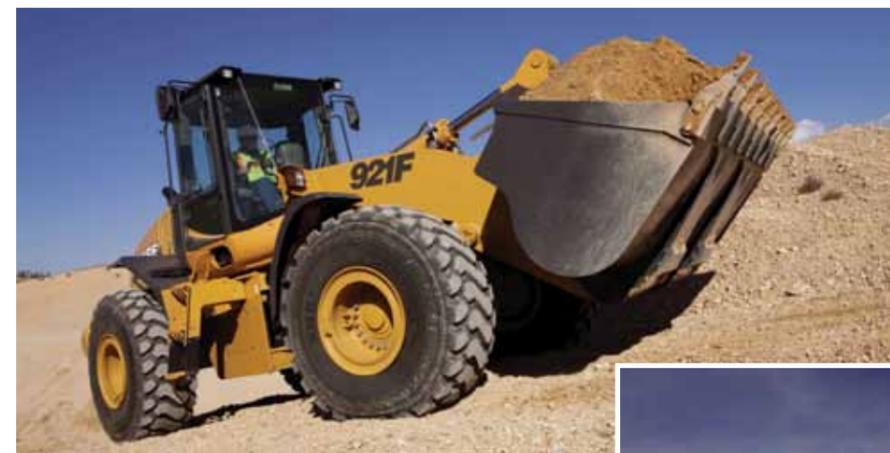
La capacidad de carga del balde va desde los 2,5 m<sup>3</sup> hasta los 3,6 m<sup>3</sup> según cada modelo.
