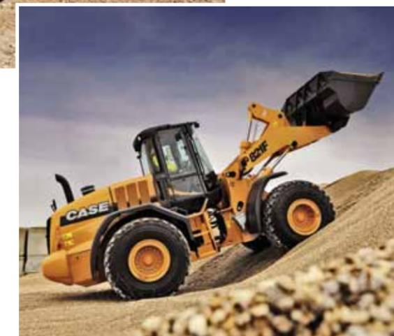
del operador. La cabina ofrece una vista libre de obstáculos hasta los bordes del balde y el aditamento, mientras una ventana lateral y un capó inclinado proveen una clara visión hacia atrás.
