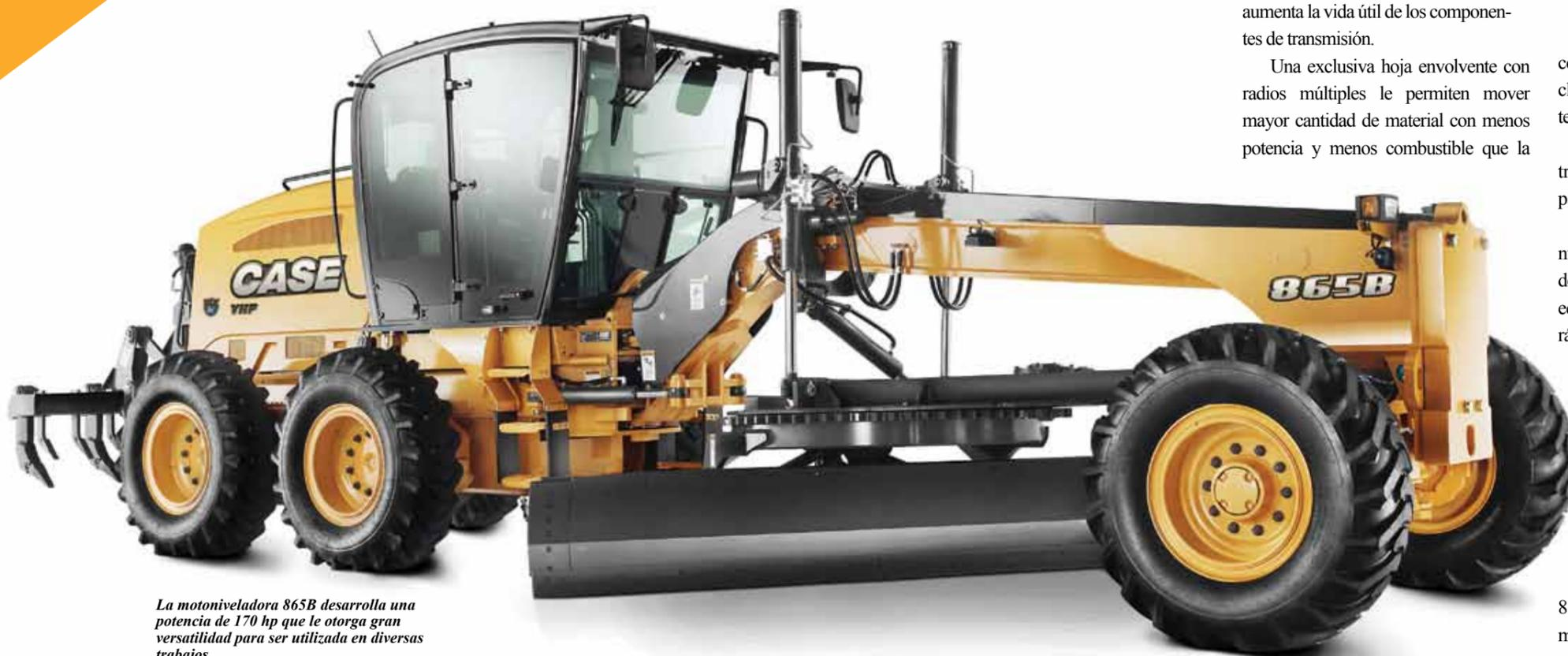
La motoniveladora 865B desarrolla una potencia de 170 hp que le otorga gran versatilidad para ser utilizada en diversas trabajos.
