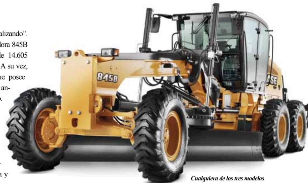
Cualquiera de los tres modelos pueden usarse con una escarificadora, un bloque de empuje, un desgarrador trasero, una hoja topadora y un contrapeso montado en la parte delantera.
