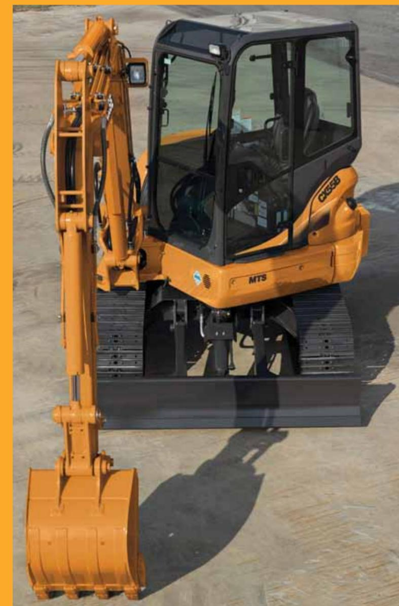
El equipo puede usarse con una gama de accesorios, como martillos, perforadores de suelo y cizallas hidráulicas; además de la cuchara con el que tradicionalmente se usa.
