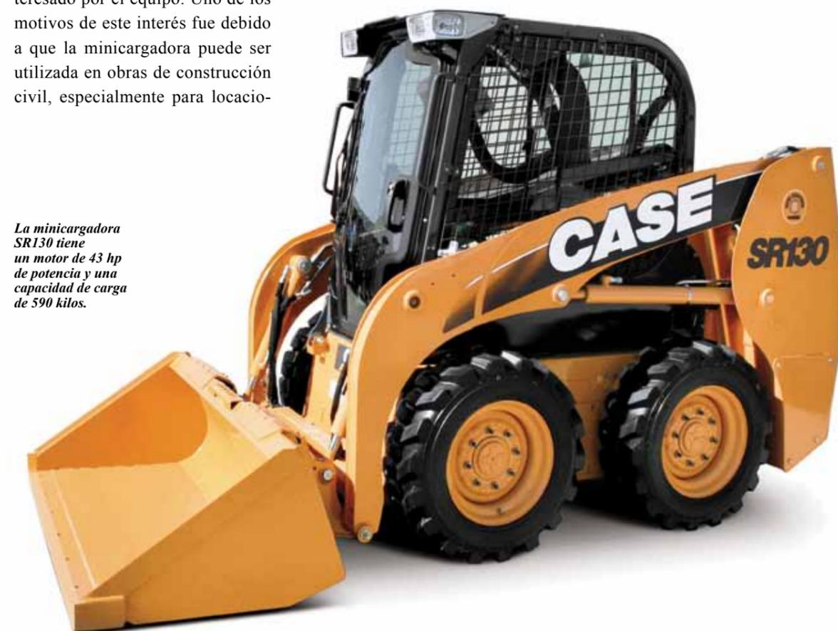
La minicargadora SR130 tiene un motor de 43 hp de potencia y una capacidad de carga de 590 kilos.
