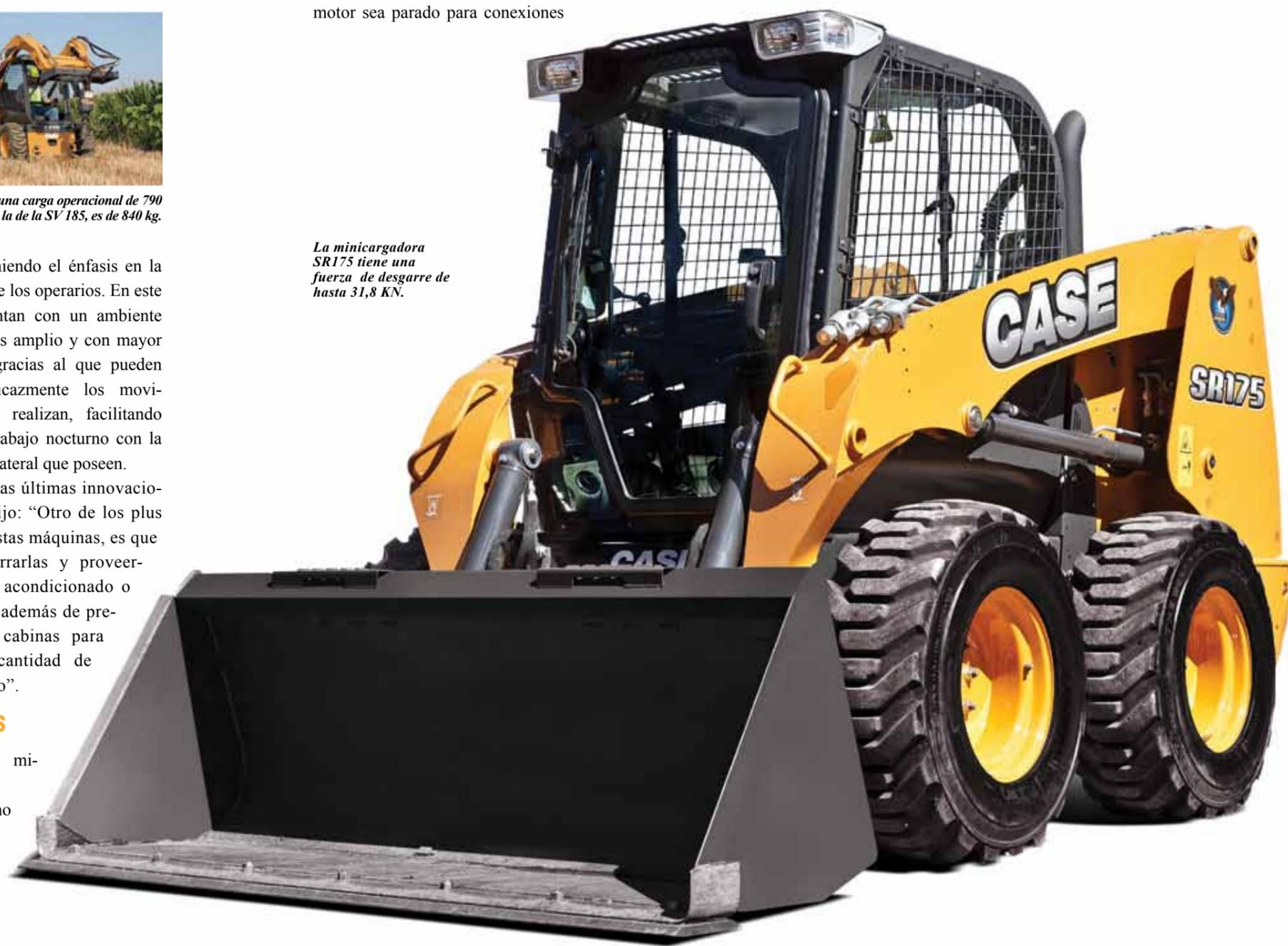
*La minicargadora SR175 tiene una fuerza de desgarre de hasta 31,8 KN.*
