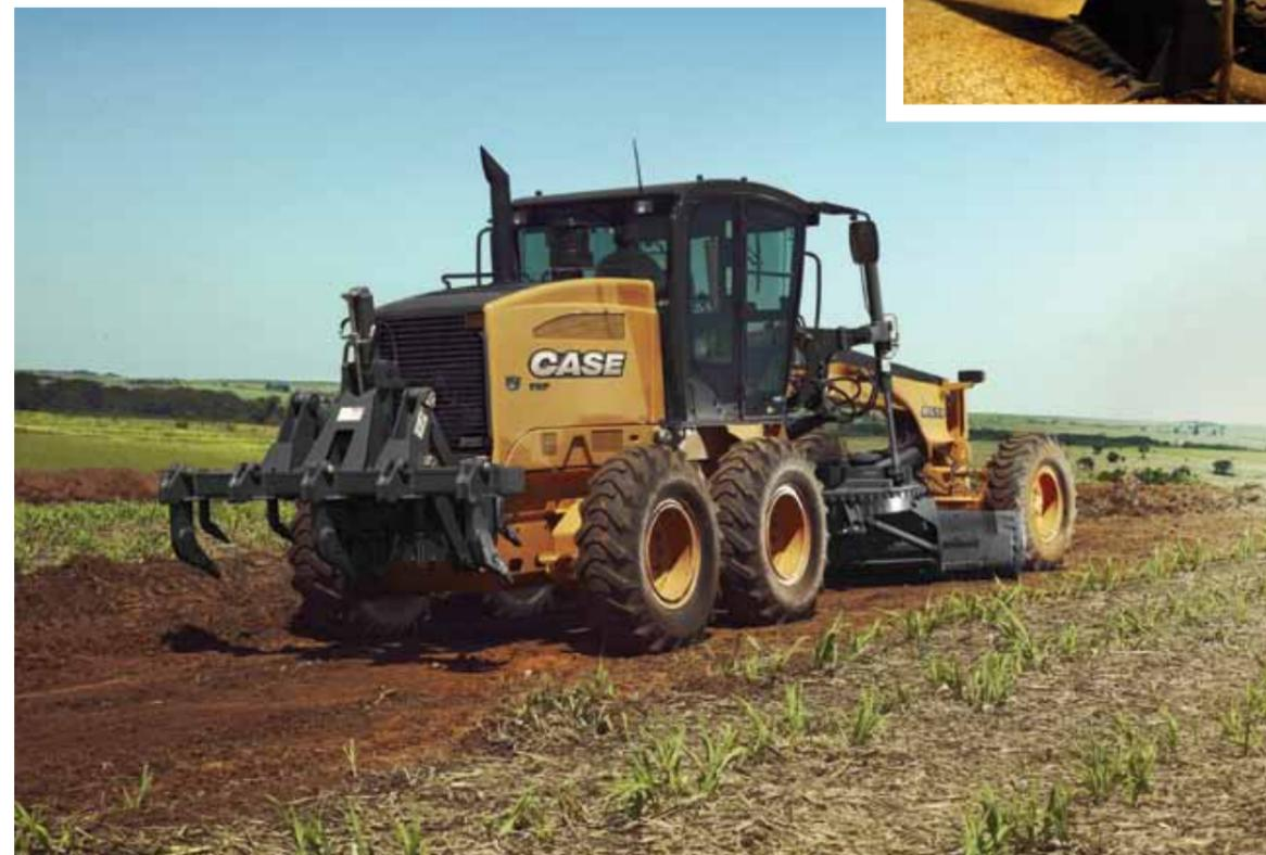
La motoniveladora 865B cuenta con un motor con una potencia bruta de 175 hp.
