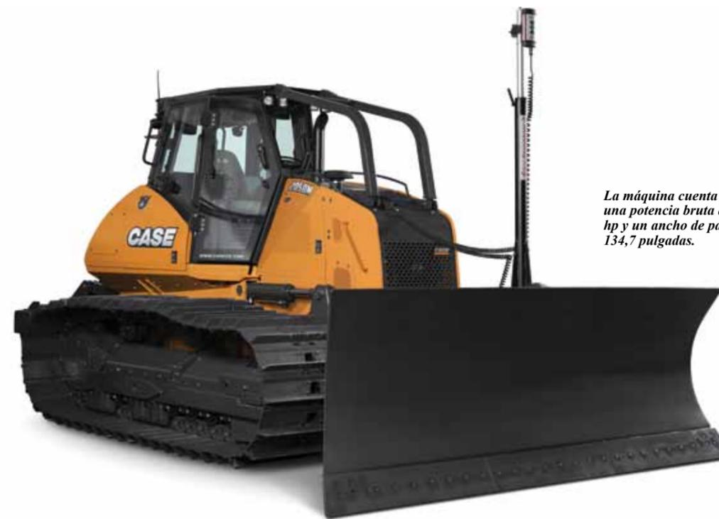
La máquina cuenta con una potencia bruta de 232 hp y un ancho de pala de 134,7 pulgadas.
