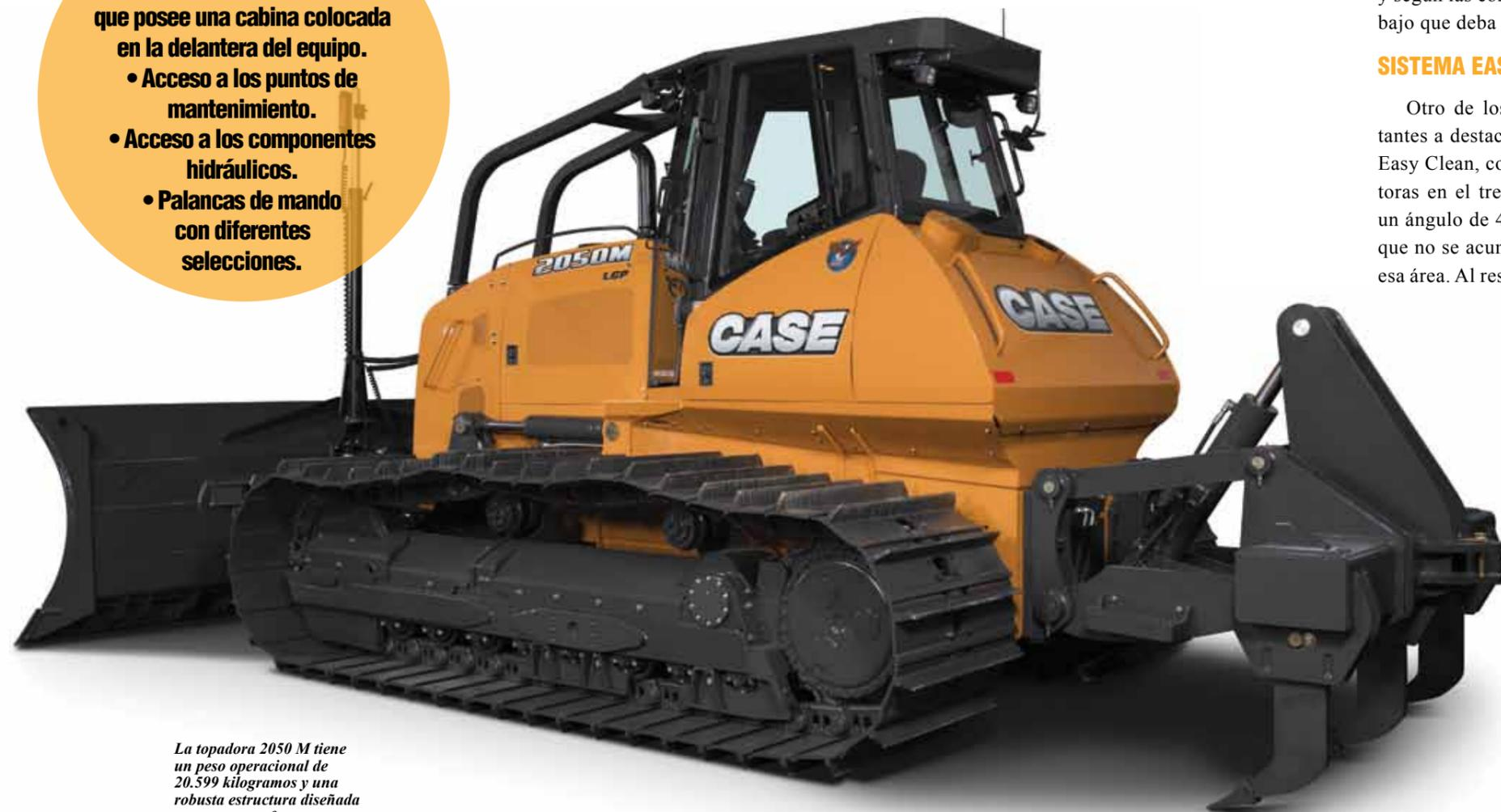
La topadora 2050 M tiene un peso operacional de 20.599 kilogramos y una robusta estructura diseñada para soportar fuerzas extremas de la hoja.
