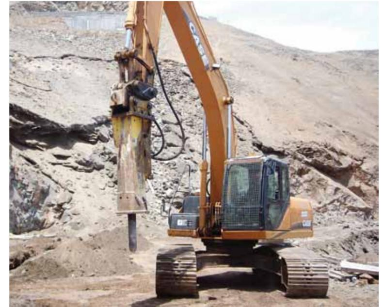
La excavadora lleva una de las rejillas de seguridad que protegen ante el desprendimiento de material.
