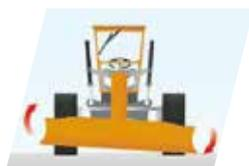
**SENSOR DE INCLINAÇÃO DA LÂMINA**
