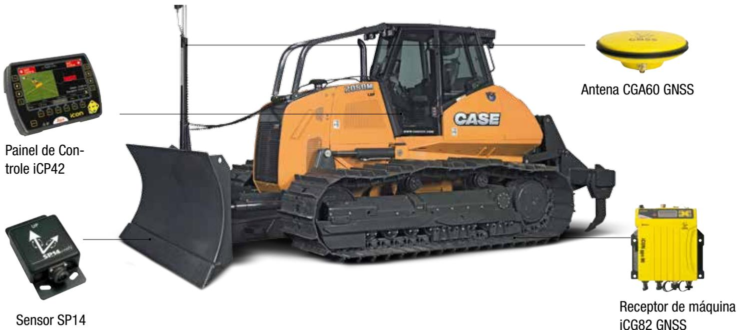
Combinando a Tecnologia SP com uma solução de dupla antena GNSS, o cliente pode operar sua máquina na velocidade máxima, enquanto a lâmina é inclinada para controlar eficientemente o material passada à passada.
