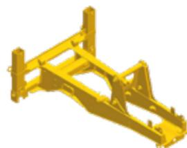
Las grandes estructuras de la sección de la caja, con fabricación, fundición y forjado gruesos de múltiples placas se utilizan en zonas de alto estrés como la punta de la pluma, la base de la pluma, el cilindro de la pluma y el pie de fijación para mejorar la durabilidad.
