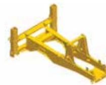
El diseño del marco estructural de dos piezas, soldado robóticamente, brinda una base robusta y fiable para la máquina que mejora la estabilidad, el rendimiento y la capacidad de servicio.
