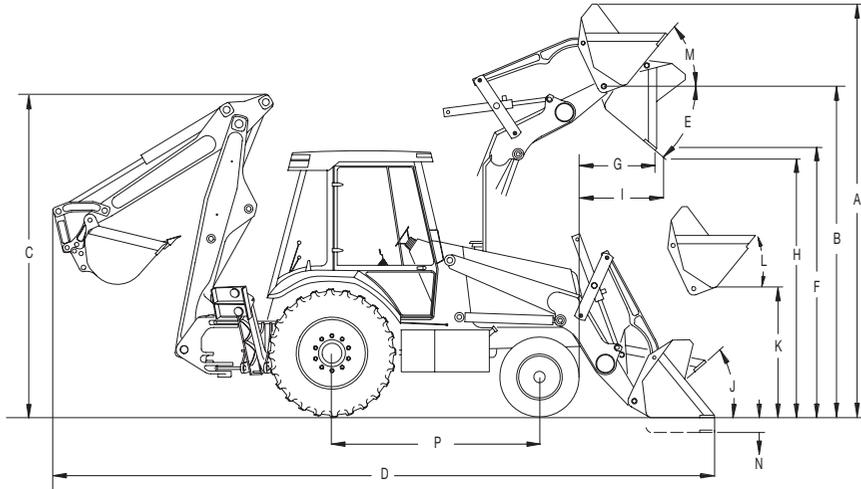
Tracción 4x4 con neumáticos traseros 19,5x24 y cucharón delantero de uso general de 93".
