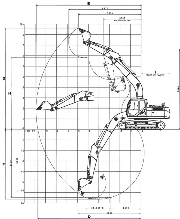
ALCANCE DE EXCAVACIÓN CON BRAZO DE 2,40 M (7' 10,5")
