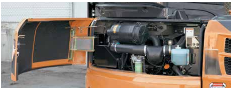
A porta de acesso ao motor permite fácil acesso ao filtro de ar, verificação do nível do óleo e reabastecimento, transbordo de líquido de arrefecimento e ao filtro de combustível.
