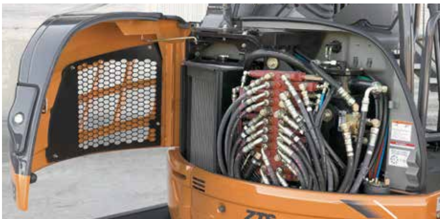
O painel de acesso simples e articulado fornece acesso aos componentes de resfriamento, válvulas e à válvula de mudança do padrão de controle do operador.
