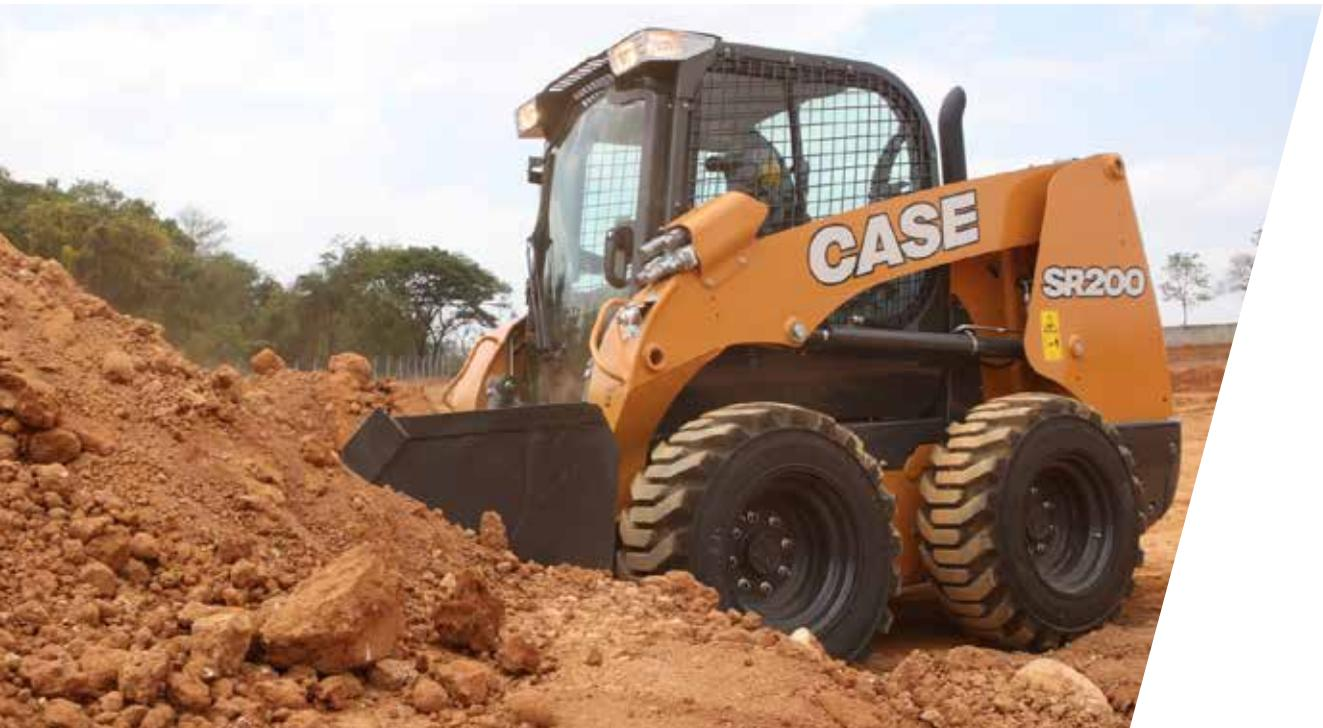
Com um acoplador rápido, você pode trocar implementos sem sair da cabine.
