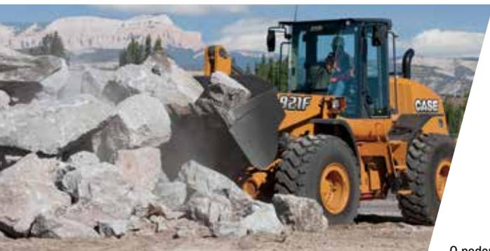
A carregadeira frontal 921F com caçamba de 3,63 m<sup>3</sup> (4,75 yd<sup>3</sup>) apresenta uma nova categoria de pá carregadeira da **CASE**. Ao oferecer maior potência líquida, maior carga de tombamento e força de desagregação, o modelo 921F atende às aplicações para materiais agregados e operação de carga de caminhões de alta produtividade.
