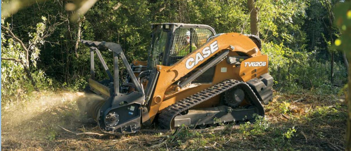
Desde el cucharón de servicio pesado de 84 in hasta los accesorios, como los cabezales de triturado y la perfiladoras en frío, la TV620B con sistema hidráulico estándar de flujo alto, y sistema hidráulico de flujo alto mejorado opcional, está fabricada para los trabajos más pesados que pueda realizar una CTL.
