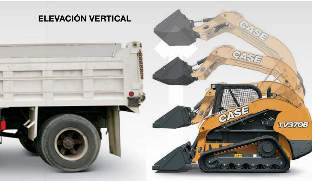
Las máquinas de elevación vertical están diseñadas para elevación, transporte y carga de camiones. La geometría de los brazos dobles permite que la carga suba directamente, lo que proporciona un alcance máximo con una máxima altura. Las máquinas de elevación vertical son ideales para alcanzar el lado y el centro de los camiones de gran altura.
