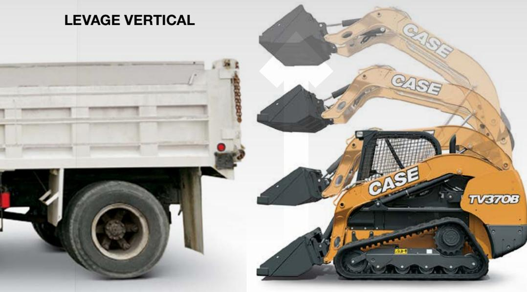
Les machines à levage vertical sont conçues pour le chargement des camions et les applications de levage et de transport. La géométrie du double bras permet de soulever la charge directement vers le haut et d'atteindre une portée maximale à pleine hauteur. Les machines à levage vertical sont idéales pour passer au-dessus des côtés latéraux des camions à haute paroi et descendre à l'intérieur de ceux-ci.
