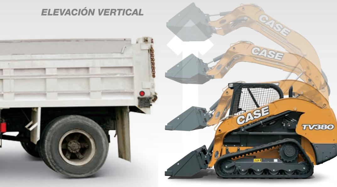
Las máquinas de elevación vertical están diseñadas para elevación, transporte y carga de camiones. La geometría de los brazos dobles permite que la carga suba directamente, lo que proporciona un alcance máximo con una máxima altura. Las máquinas de elevación vertical son ideales para alcanzar el lado y el centro de los camiones de gran altura.
