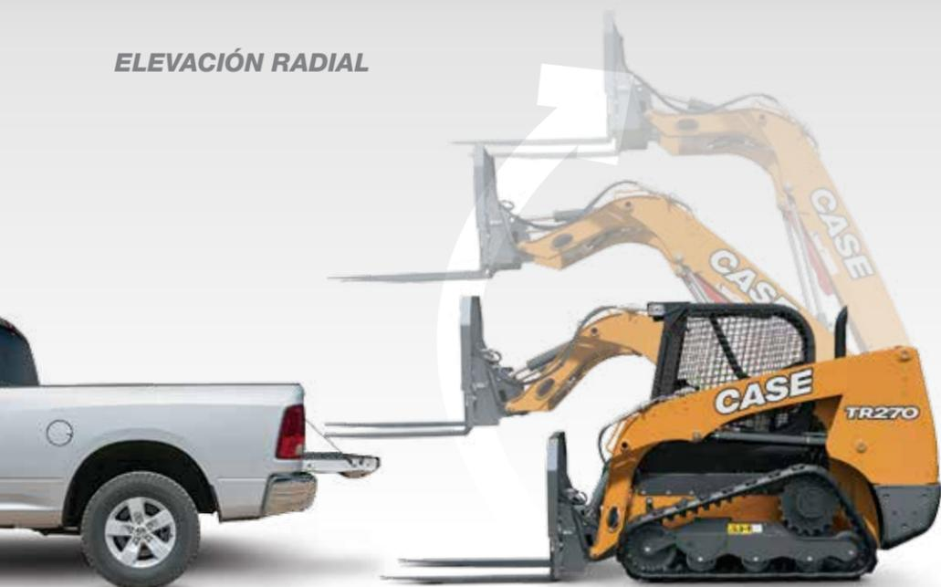
Las máquinas de elevación radial están diseñadas para excavar, levantar y empujar. El ángulo del brazo se conecta directamente en el chasis para lograr una resistencia superior cuando se realizan tareas de excavación y empuje. Además, proporciona un alcance máximo a la altura de la cabeza del operador, ideal para cargar y descargar los palés de los camiones.
