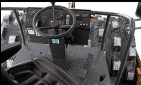
La palanca integrada de desplazamiento controla la velocidad, la dirección y la vibración.
