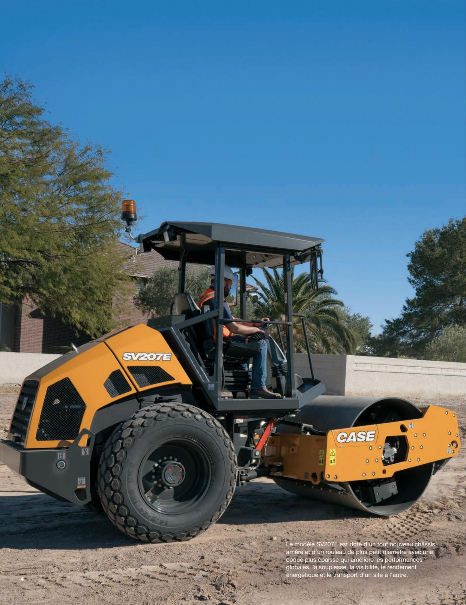
Le modèle SV207E est doté d'un tout nouveau châssis arrière et d'un rouleau de plus petit diamètre avec une coque plus épaisse qui améliore les performances globales, la souplesse, la visibilité, le rendement énergétique et le transport d'un site à l'autre.
