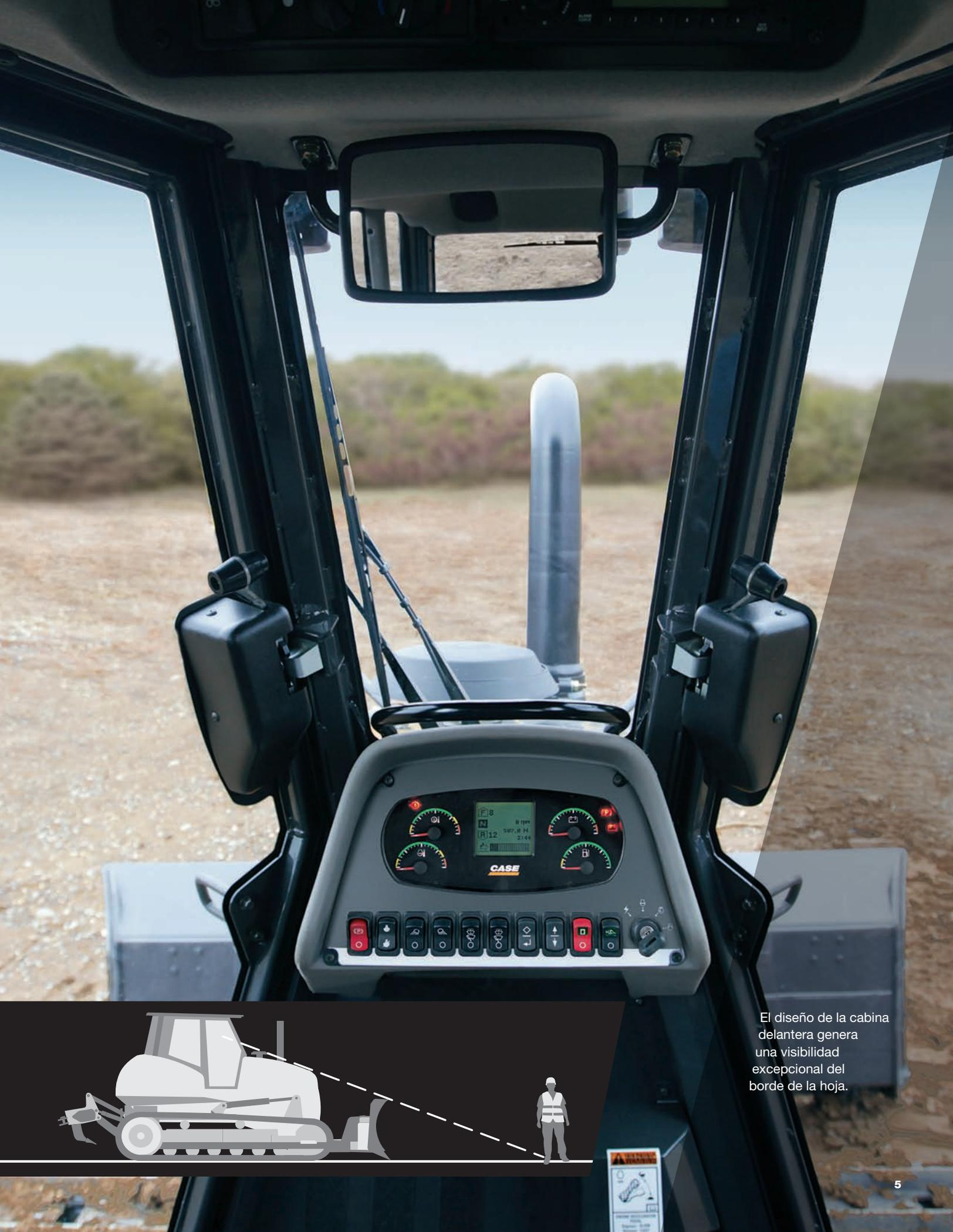
El diseño de la cabina delantera genera una visibilidad excepcional del borde de la hoja.
