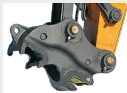
**ACOPLADOR HIDRÁULICO RÁPIDO INTEGRADO**
