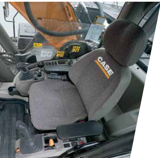
Le siège à suspension pneumatique est de série.
