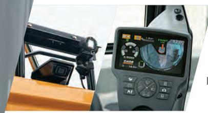
La caméra arrière de série des machines de la série D offre une plus grande visibilité de l'arrière de la machine; l'ajout de la caméra latérale ou de l'écran Max View de en option offre une meilleure visibilité autour de la machine pour une utilisation plus sécuritaire.
