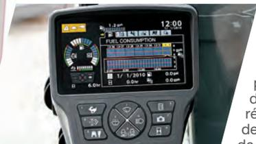
L'écran ACL antireflet multifonction de 7 po à collage optique affiche une abondante quantité de données d'utilisation de la machine, ainsi que des données de configuration et d'entretien. Appuyez sur un bouton pour obtenir des renseignements à jour au sujet du niveau de carburant, de la température et des régulateurs de pression. Un autre bouton fournit des renseignements sur les heures et la consommation de carburant pour jusqu'à deux déplacements.
