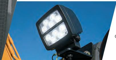
Les 8 phares de travail à DEL placés autour de la cabine et de la flèche offrent plus de trois fois la luminosité des ampoules halogènes : deux montés à l'avant de la cabine, deux montés à l'arrière et un de chaque côté, sur le phare et sur la flèche.
