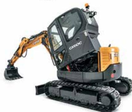
La CX60C también dispone de una cabina inclinable para tener un mayor acceso a los puntos de mantenimiento.
