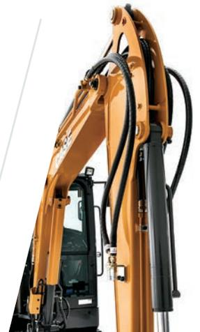
Sistema hidráulico auxiliar
