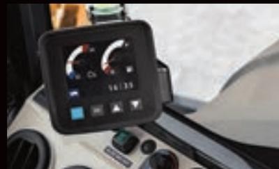
La amplia cabina del modelo CX55B ofrece una pantalla LCD opcional.
