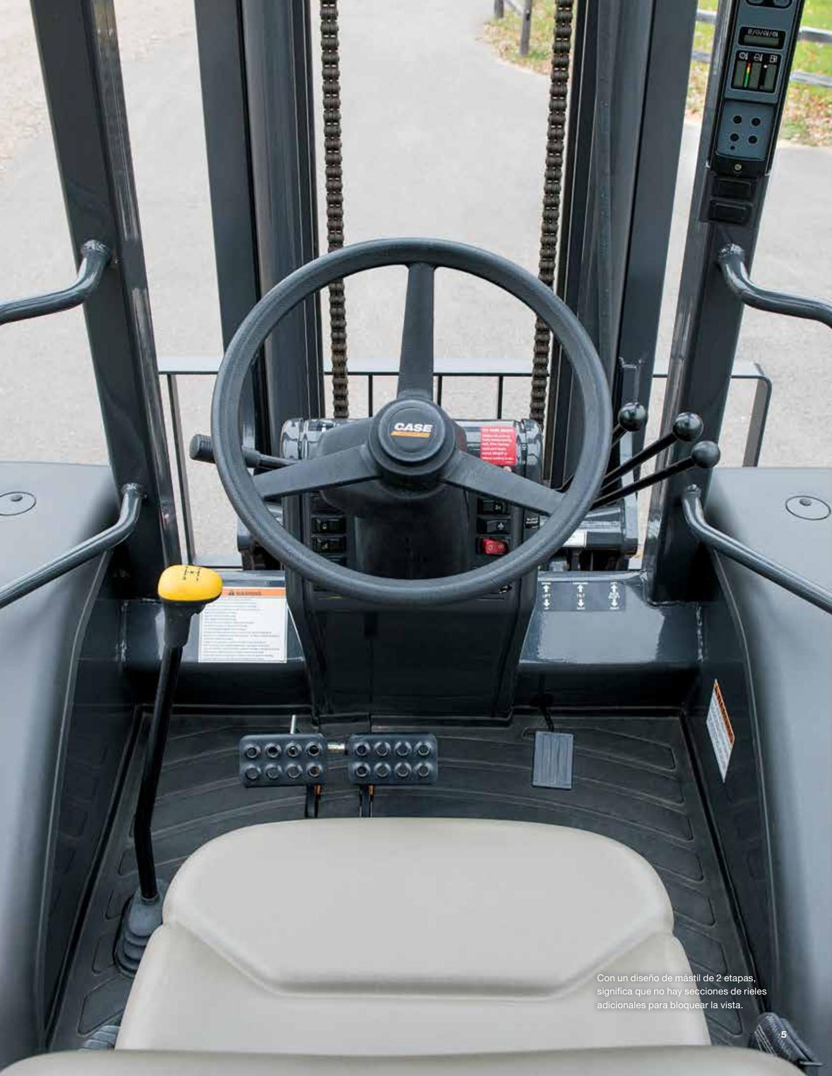
Con un diseño de mástil de 2 etapas, significa que no hay secciones de rieles adicionales para bloquear la vista.
