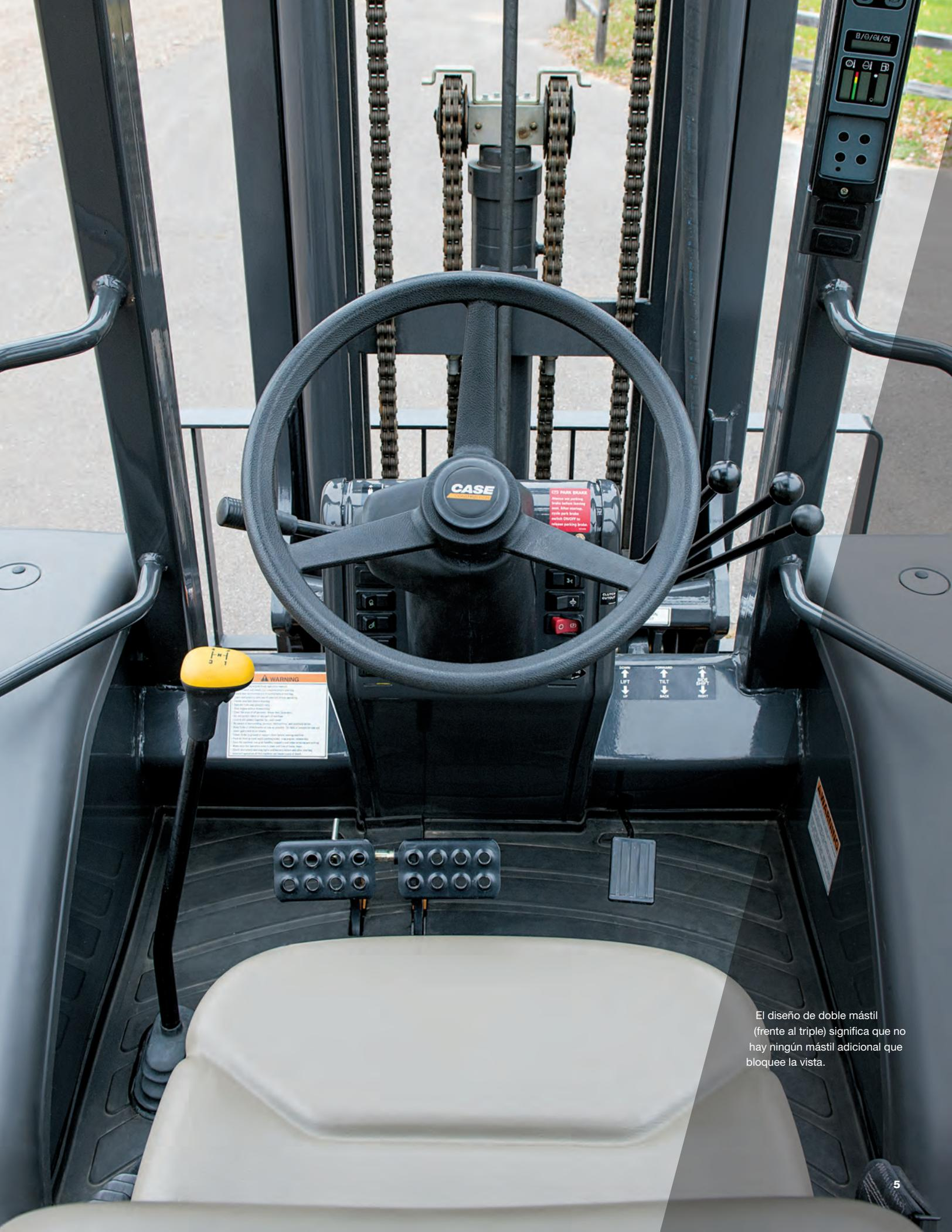
El diseño de doble mástil (frente al triple) significa que no hay ningún mástil adicional que bloquee la vista.
