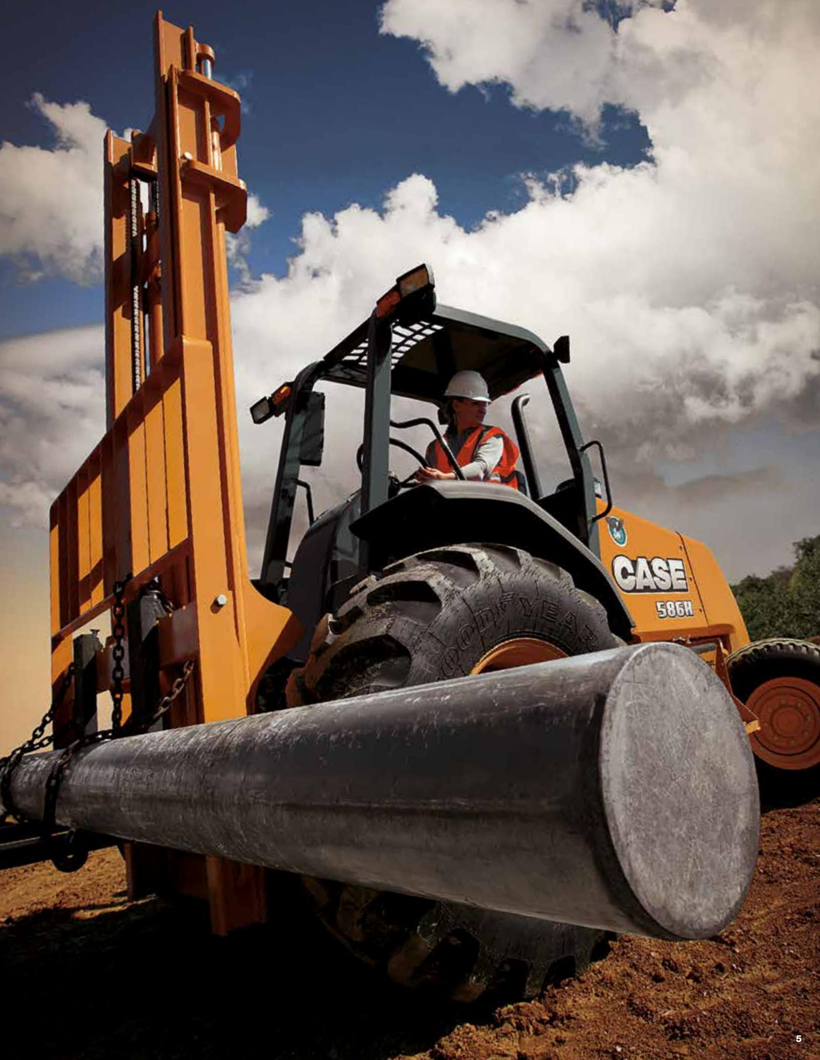
El diseño de dos mástiles (en vez de tres) significa que no hay un mástil adicional que reduzca la visibilidad.
