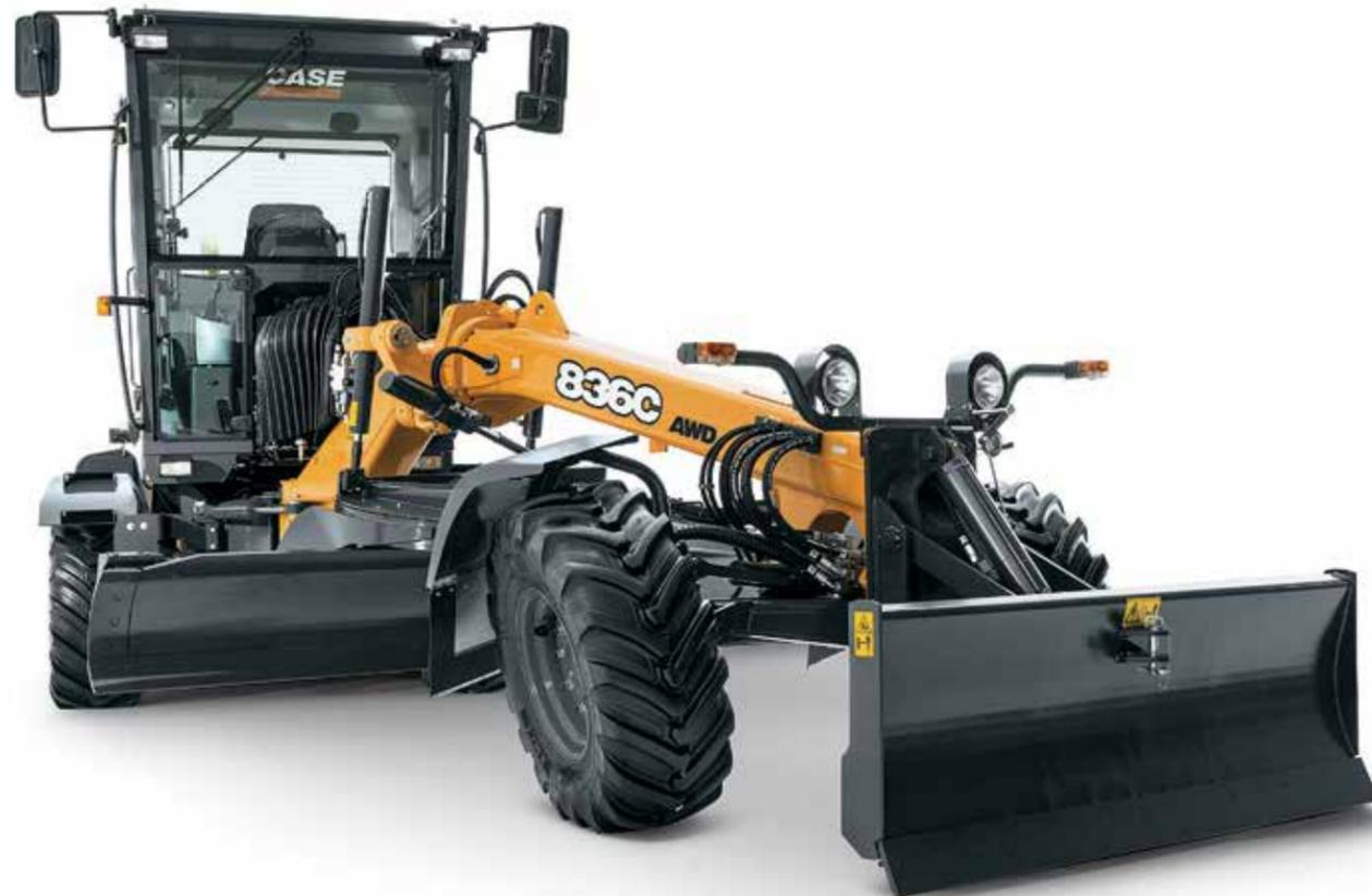
Le modèle illustré comprend les commutateurs de configuration de commandes de machine en option montés de chaque côté des commandes conventionnelles.
