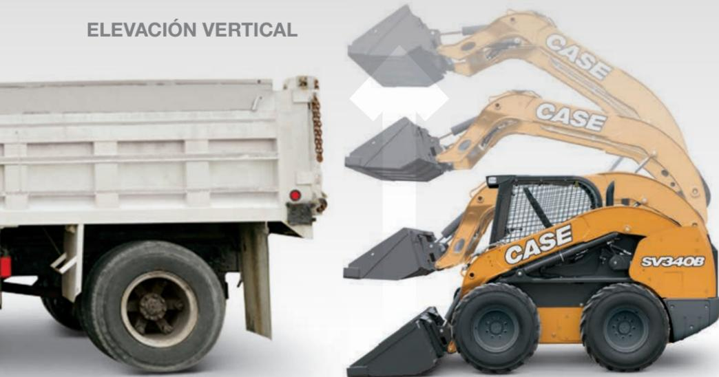
Las máquinas de elevación vertical están diseñadas para elevación, transporte y carga de camiones. La geometría de los brazos dobles permite que la carga suba directamente, lo que proporciona un alcance máximo con una máxima altura. Las máquinas de elevación vertical son ideales para alcanzar el lado y el centro de los camiones de gran altura.
