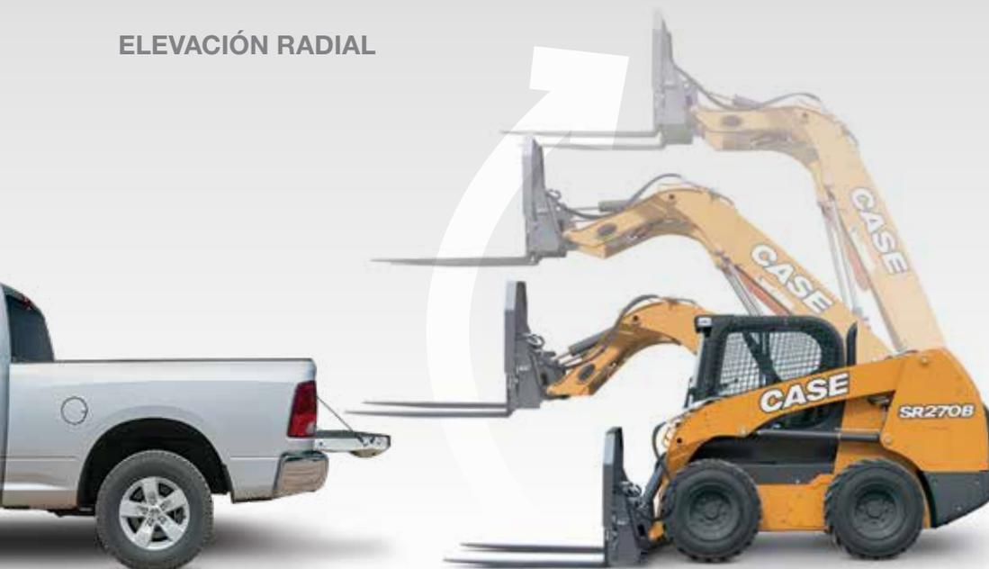
Las máquinas de elevación radial están diseñadas para excavar, levantar y empujar. El ángulo del brazo se conecta directamente en el chasis para lograr una resistencia superior cuando se realizan tareas de excavación y empuje. Además, proporciona un alcance máximo a la altura de la cabeza del operador, ideal para cargar y descargar los palets de los camiones.
