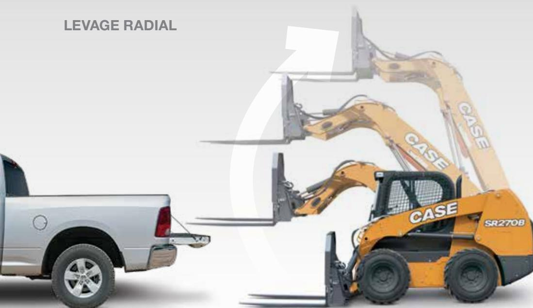
Les machines à levage radial sont conçues pour creuser, faire levier et pousser. L'angle des bras les fixe directement sur le châssis pour une force supérieure en creusant et en poussant. Il offre aussi une portée maximale à la hauteur de la tête de l'opérateur, ce qui le rend parfait pour le chargement et le déchargement de palettes de camions.
