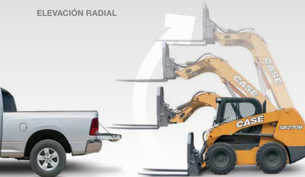
Las máquinas de elevación radial están diseñadas para excavar, levantar y empujar. El ángulo del brazo se conecta directamente en el chasis para lograr una resistencia superior cuando se realizan tareas de excavación y empuje. Además, proporciona un alcance máximo a la altura de la cabeza del operador, ideal para cargar y descargar los palés de los camiones.
