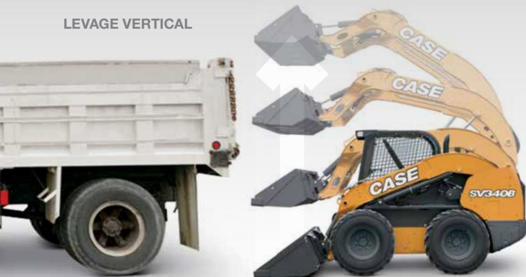
Les machines à levage vertical sont conçues pour le chargement des camions et les applications de levage et de transport. La géométrie du double bras permet de soulever la charge directement vers le haut et d'atteindre une portée maximale à pleine hauteur. Les machines à levage vertical sont idéales pour passer au-dessus des côtés latéraux des camions à haute paroi et descendre à l'intérieur de ceux-ci.
