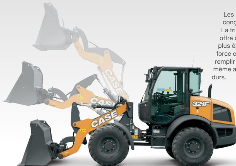
Les machines à barre en Z sont conçues pour creuser et ramasser. La tringlerie durable à barre en Z offre des forces d'arrachements plus élevées pour creuser avec force et en profondeur, et pour remplir complètement les godets, même avec les matériaux les plus durs.
