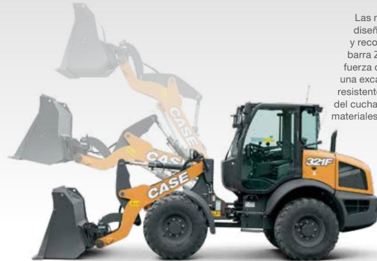
Las máquinas con barra Z están diseñadas para excavación y recolección. El varillaje de barra Z duradero ofrece mayor fuerza de desprendimiento para una excavación más potente y resistente, y un llenado completo del cucharón, incluso con los materiales más duros.
