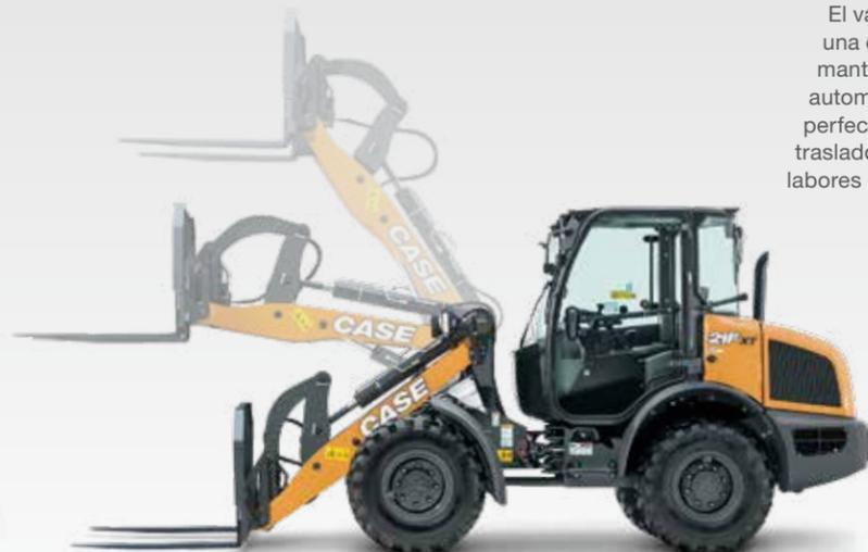
El varillaje XT proporciona una elevación paralela, lo que mantiene las cargas niveladas automáticamente; esto lo hace perfecto para la elevación y el traslado, además de para las labores de llenado de camiones.
