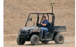
iCON gps 60/70T son las estaciones base móviles perfectas para su sitio de construcción. No necesita un controlador con configuración de estación base. Transmite correcciones a través de Internet y sin radio.
