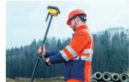
Use iCON gps 60/70T para el control de la máquina como instalación de nivel inicial. iCON gps 60/70T ofrece más flexibilidad para los contratistas más pequeños que también necesitan una solución de poste GNSS, pero no todo el tiempo. Pueden usar las mismas herramientas dentro y fuera de la máquina.
