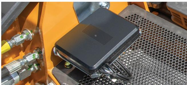
El nuevo módulo SiteConnect mejora el volumen, el flujo y la integración de los datos en la plataforma de telemática SiteWatch de CASE y permite realizar diagnósticos, borrar códigos y actualizar software de forma remota. Con el módulo SiteConnect de CASE, sabe que está conectado.
