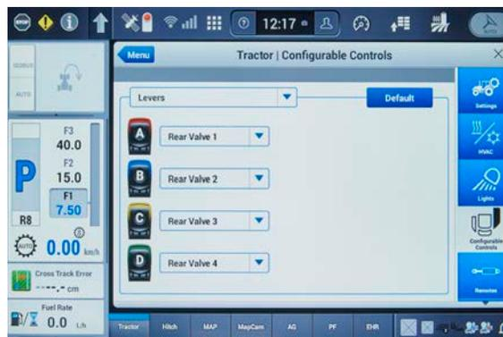
«Горячие клавиши» обеспечивают непосредственный доступ к меню настроек для конфигурирования параметров дистанционных клапанов.
