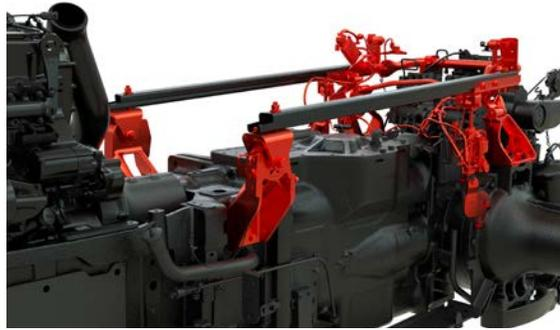
Полуактивная гидравлическая подвеска кабины надежно гасит колебания и вибрации.
