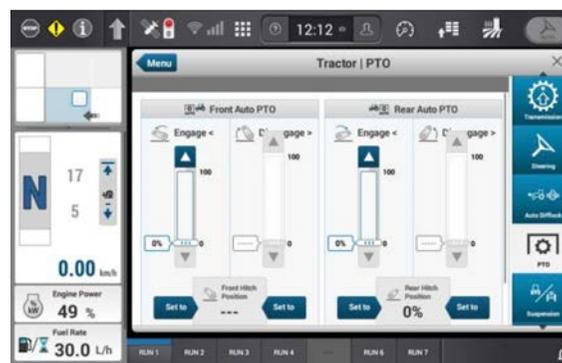
Интуитивно понятная компоновка настроек автоматического включения/выключения переднего и заднего вала отбора мощности в зависимости от высоты
