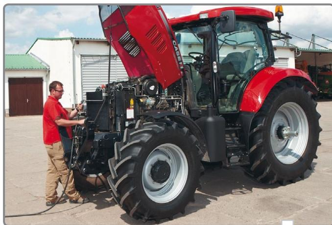
Простые ежедневные проверки и очистка с новыми откидными охладителями. Воздушный фильтр удобно расположен для быстрой проверки. Уровень масла можно проверить, не открывая капот.
