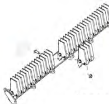
Nuevo picador de alto rendimiento 40 cuchillas para el modelo 8230 y el 9230.
