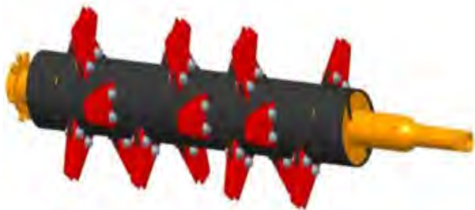
Nuevo sistema de contracuchillas del picador para el modelo 8230 y el 9230.
