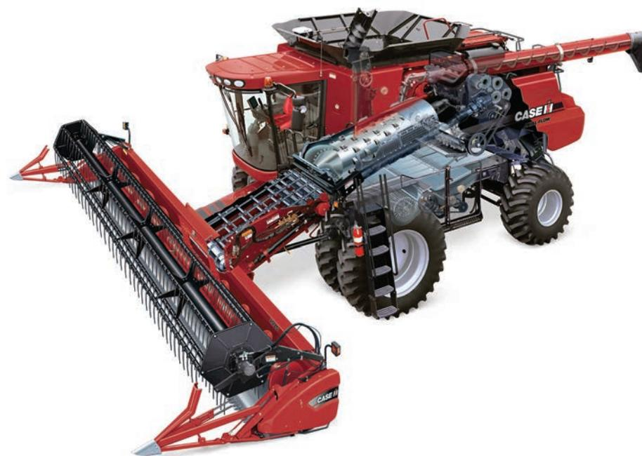
La CVT, Transmisión continua variable, proporciona un eficiente accionamiento mecánico que varía hidráulicamente, elimina gran cantidad de correas de transmisión y ofrece un control automático de velocidad variable de alimentador y plataforma.
