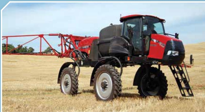
foi projetado para auxiliar em situações adversas, como a passagem por curva de nível. O conjunto de tração inteligente regula o fluxo de óleo nas quatro rodas. “Com o acionamento do pedal de bloqueio, o sistema divide a vazão de óleo em quatro fluxos independentes e faz com que as rodas trabalhem individualmente, con-
