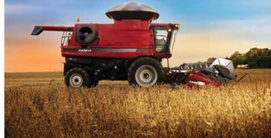
El eje delantero fue reposicionado 13 centímetros hacia adelante para que no sea necesario colocar contrapesos al utilizar cabezales más grandes.
