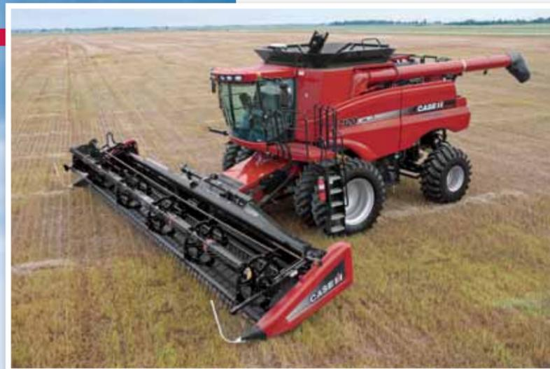
La cosechadora se puede utilizar con varios tipos de cabezales, como con el de lona con tecnología Draper
