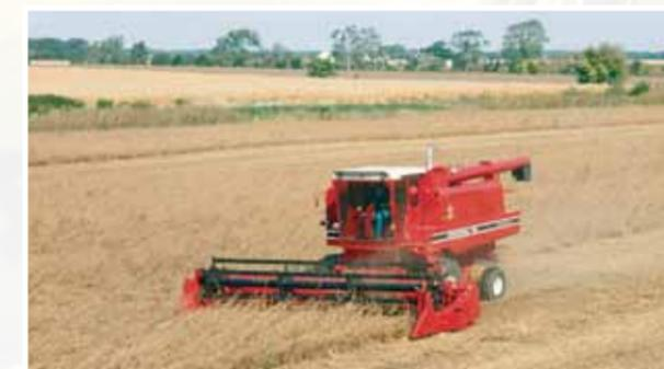
La cosechadora Axial-Flow 1460, una de las pioneras del sistema axial.
