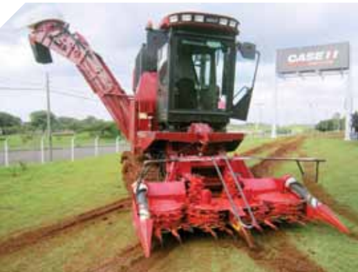
A colhedora protótipo da Case IH é parte fundamental para a produção do combustível feito a partir do sorgo sacarino
